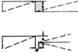
NIVEL INFERIOR DE TECHOS MULTI-NIVELES (CUANDO EL TECHO SUPERIOR ES PARTE DEL MISMO EDIFICIO O DE UN EDIFICIO ADYACENTE A NO MAS DE 4.5 m.)
